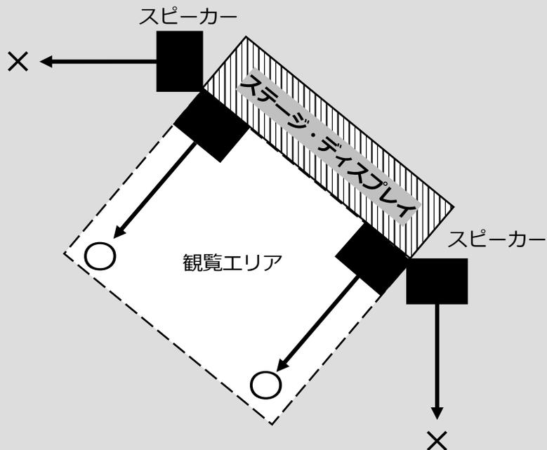
②通路に向けてスピーカーを設置する場合は、**スピーカーの中心軸が通路を挟んで隣接する小間との境界中心線を超えてはいけません。**スピーカーを造作物に組み込む場合も同様です。
