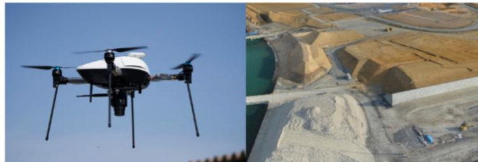
▲空撮測量に使用されるドローン（左）と空撮画像（右）。（エアロセンス提供）
